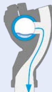
Per collegare o scollegare dispositivi e strumenti in modo sicuro, devono essere utilizzati gli attacchi rapidi Transair® con protezione integrata contro i colpi di frusta, secondo la ISO 4414.
